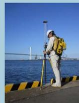
1人で、簡易な装備 (アンテナ・受信機・通信装置) でGNSS観測を行い、観測したデータを配信事業者へ電話回線で送信し、電子基準点の成果に基づいた観測点の位置 (X, Y, Z) をリアルタイム (その場で、1秒ごとに) に求めることができる。
