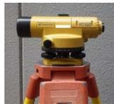
水準測量に用いられる機器。レンズを覗くと視準線が**常に水平に保たれる構造**になっており、標尺(スタッフ)の値を読み取ることで、高低差を測定する。
