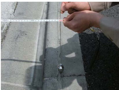
スチールテープとさげふりによる距離測定
