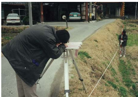
平板と綿テープによる平面図作成
