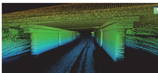
(図4) SLAMによる橋梁下計測
