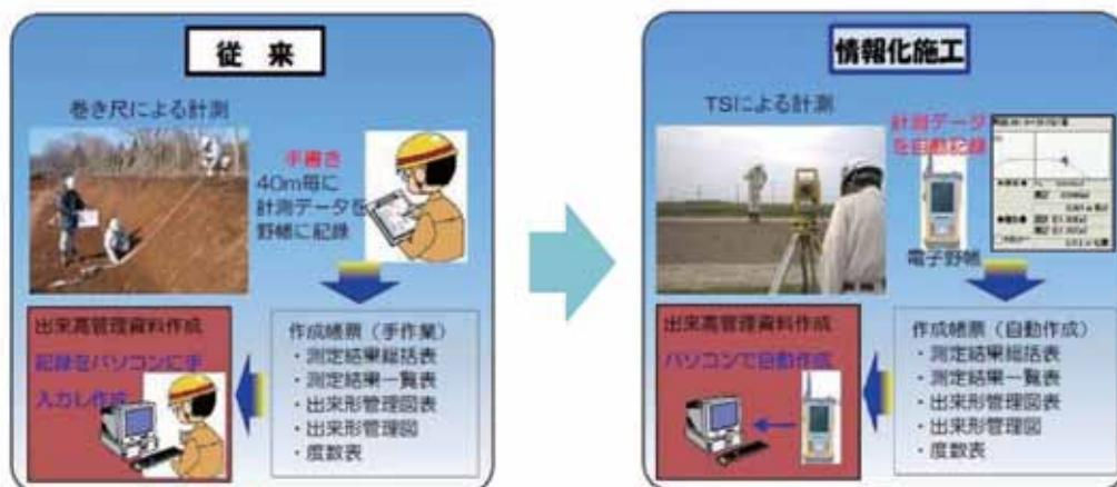
従来の施工管理と情報化施工による施工管理の比較
