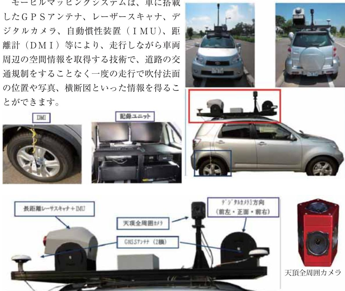
モービルマッピングシステムの車両概要（機器構成）
