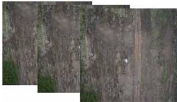
UAV の撮影は、カメラを垂直方向に向け、右の写真のように連続して撮影。
