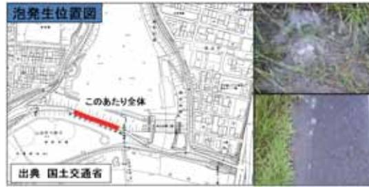
図-16 豪雨・高水位時の天端でのエアブローの発生事例
