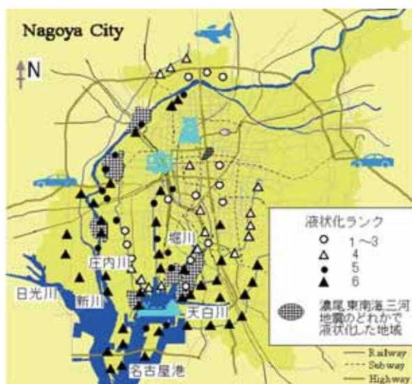
図-5 名古屋市における液状化危険度分布： 地盤工学会中部支部，最新名古屋地盤図」の図を基に加筆，アレンジしたもの
