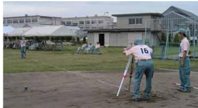
第一次作業は、各チームがスタートの合図とともに競技を開始し、平板測量を実施しました。先棒が走って測点に行ってポールをたて、器械マンがアリダードで方向を覗き、巻尺にて距離を測り平板上に記す。終わったら次の測点に移動して、同じ作業を繰り返す。すばやく五角形を完成させ、最初の測点にどれだけ正確に戻ってくるかを競いました。
