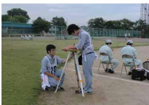
第二次作業は、一次作業で行った平板測量にて作図した五角形の各測点間の距離及び対測の距離を測定しました。
