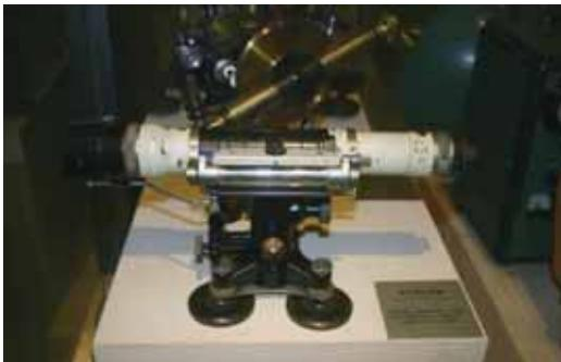
1924(大正13)年から1955(昭和30)年頃に、一等水準測量に使用された。望遠鏡の倍率は36倍。気泡管は合致式で、その感度は $10'' / 2$  mmである。また、ツアイスⅢ型は、平行平面ガラス・マイクロメーターを付けていた。ツアイス社が、Ⅲ型に平行平面ガラス・マイクロメーターを付けたのは1912年のことである。
