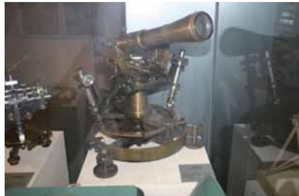
機器の大きさ 望遠鏡の長さは56cm 望遠鏡の倍率は54倍 収納箱のサイズは、L56 × W41 × H58 (cm)
