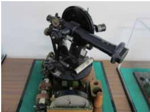
1 / 1万、1 / 5万地形図作成のための図根点測量に使用された経緯儀である。
