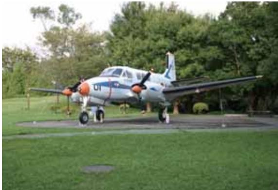
国土地理院が1960（昭和35）年に導入した初代の測量用航空機である。機内には、重さ約200kgの航空カメラを搭載し、尾部から出ている球体内には磁気センサーが格納されている。1983（昭和58）年まで全国各地の空中写真撮影及び航空磁気測量で活躍した。
