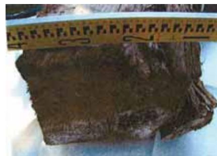
図-25 基礎盤木の断面
