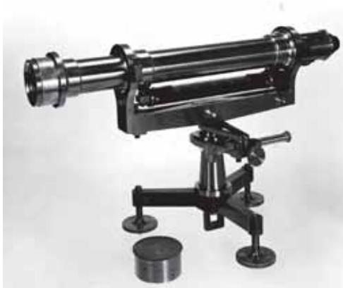
陸地測量部（1888（明治21）年）になった時点で、一等水準儀は7台保有されていたが、すべてがこのCarl Bambergであったろうと思われている。1924（大正13）年まで、一等水準測量に使用された。望遠鏡の長さは48cm 望遠鏡の倍率は36倍。気泡管感度は、4～5"/2mmである。
